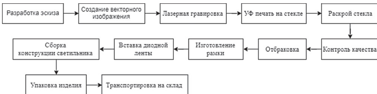
Рис. 4. Схема технологии изготовления изделия в масштабах массового производства
