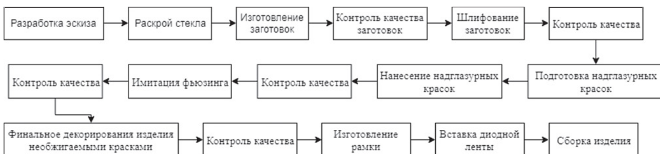
Рис. 3. Схема технологии изготовления единичного изделия
